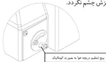
برای تنظیم دریچه هوا بصورت ثابت بایستی مهره کاسه نمدادار را در موقعیت دلخواه باندازه ای سفت کنید که دریچه ثابت باشتد. بیاد داشته باشید که طول شعله از ۳/۴ طول اطاق احتراق دیگ بیشتر نشود و همچنین قطر شعله بگونه ای نباشد که به دیواره های اطاق احتراق برخورد کند.
